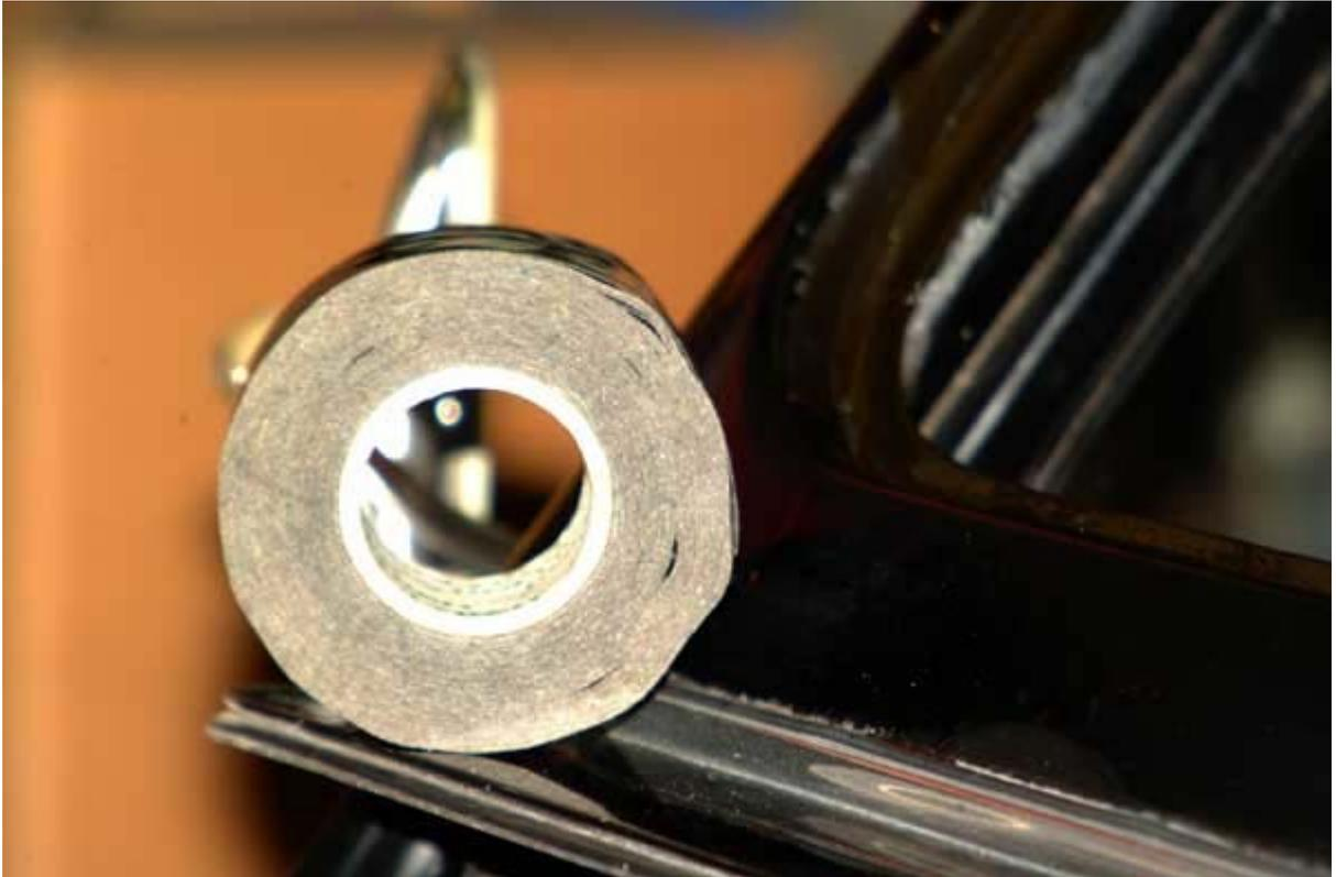
Quand la bande adhésive a été appliquée sur les trous et sur le rebord intérieur de la baie, pulvérisez une couche de cire protectrice là où le joint se loge.
