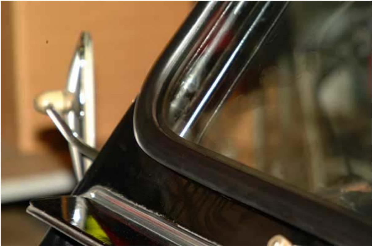
Avec une main, appuyez **légèrement** sur la vitre et avec l'autre (à l'intérieur de l'auto, donc), tirez sur le fil **perpendiculairement au joint** et **parallèlement à la vitre**. Changez de côté (et de main) pour faire l'autre partie inférieure.
