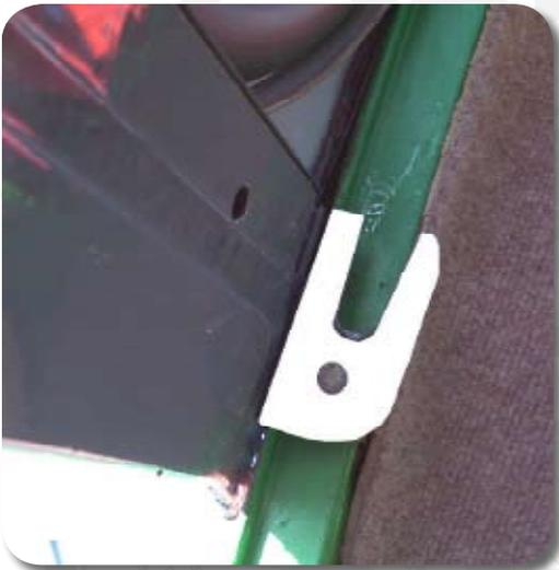
6) Si la traverse arrière de votre capote dispose des échancrures en U (Cf. photo), engagez directement votre support arrière sur ces échancrures. La Pose est terminée.
