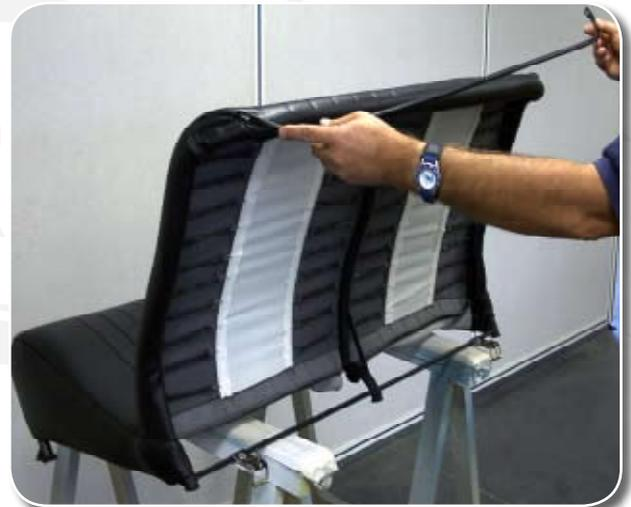
2) Percez avec précaution l'armature de la banquette, en maintenant le support en bonne position (diamètre de perçage 2 mm.)
