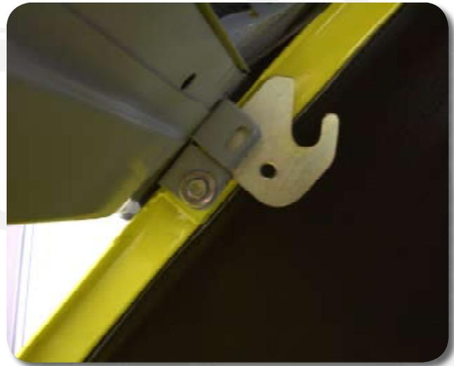
7) Si non fixez à droite et à gauche de la traverse de capote les supports (Réf. 2600100, Cf. photo). Ces supports étant taraudés supprimez les écrous cage.
