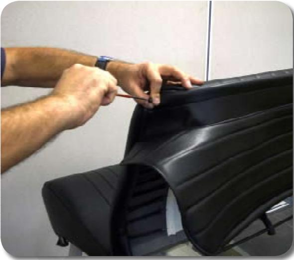
4) Fixez la plage arrière sur le haut du siège, par deux vis métal sur les extrémités.
